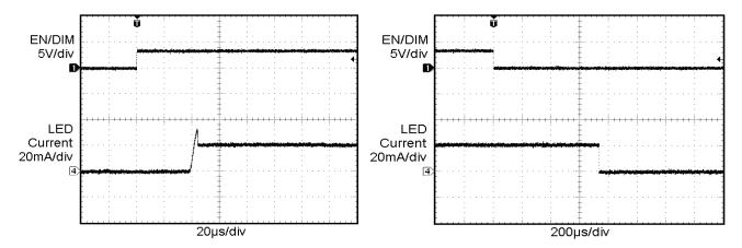
Figure 15. Power Up Delay (1x Mode)
