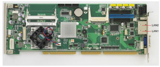
Figure 2.11 LAN RJ45 connector (LAN1/LAN2)
